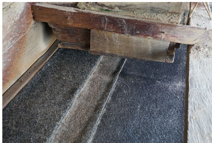
Teppichflies auf der Dragarutsche, auf dem der Schlamm mit den Goldpartikeln liegen bleibt Foto: Putz
